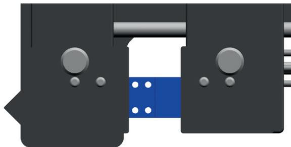
Die neue, variable Fixiereinheit 398054 beinhaltet nun die Reitstock-Funktion, einen Prismenhalter und einen Spannstock mit glatten Backen. Teilespezifische Sonderbacken sind jederzeit auf Anfrage möglich. Die Spannkraft ist über Mikrofedern sehr fein und wiederholgenau einstellbar. Reitstockspitzenpaar 60° als Zubehör 398060 erhältlich und gegen Hohlspitzen tauschbar.
