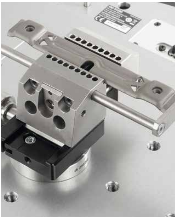
Wiederholgenaue Spannung mit verstellbarem Anschlag.
